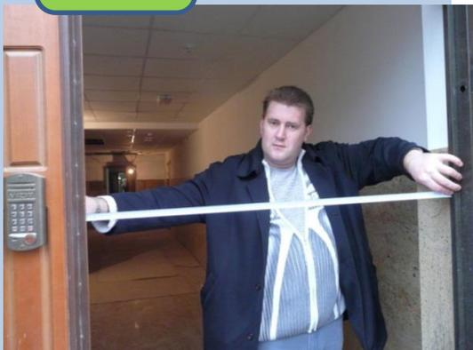
СНиП 35-01 3.23 Ширина дверных и открытых проемов в стене, а также выходов из помещений и из коридоров на лестничную клетку должна быть не менее 0,9 м.
