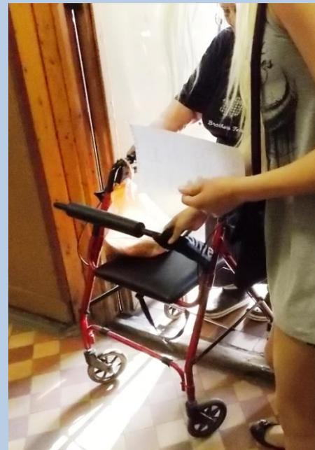
При узких тамбурах доступность для колясочников и опорников условная. Сопровождающий держит обе двери открытыми.
